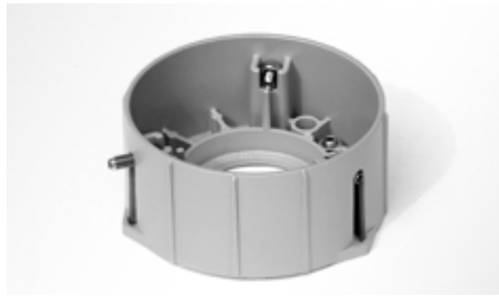
Embase de fixation au sol en aluminium moulé sous pression, peint par poudre polyester après un traitement de conversion chimique de la surface.
